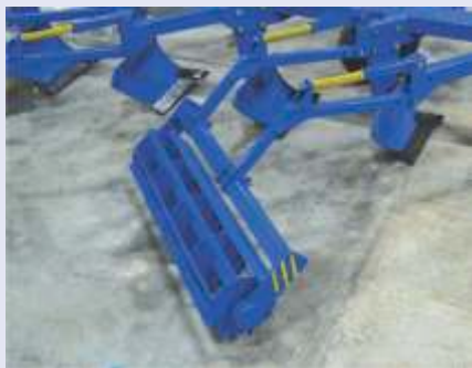
Каток реечный на два рабочих органа -1.4 Каток реечный на три рабочих органа -1.9
